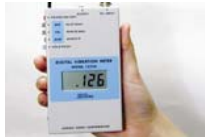
Displacement display 0.126 mm (126 μm)
